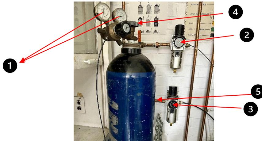
En general las presiones de salida y entrada de los gases ya se encuentran establecidas de antemano, entonces solo basta con abrir la llave del tanque de nitrógeno (4) y la llave del aire que se encuentra por detrás del tanque de nitrógeno (5) y luego solo se debe de comprobar la presión en los manómetros. En caso de que no se haya realizado la selección de los gases, ésta se realiza de la siguiente manera:
